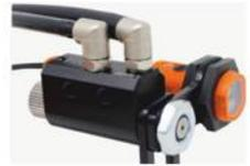
El sistema de pulverización está dotado de un sensor láser que detecta cuando la pieza a cantear pasa por delante e inmediatamente manda la orden a la parte electrónica para que se pulvericen a través de las boquillas de pulverización, los distintos agentes antiadherentes y limpiadores.
