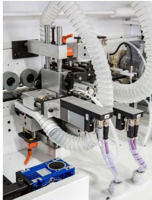
● Gruppo raschiatore DIGIT O2 con nebulizzatore di liquido anti-adesivo.
