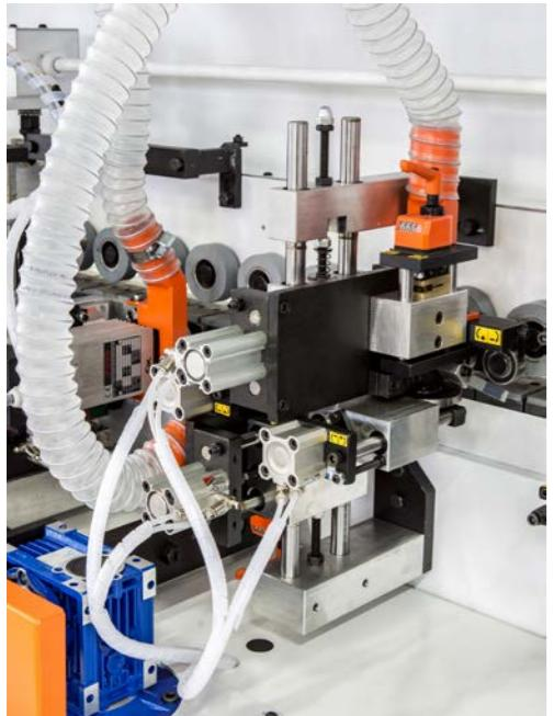
● Gruppo raschiatore PN O2 con nebulizzatore di liquido anti-adesivo.
