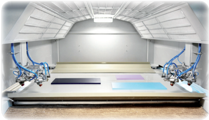
Cabine de pulvérisation avec nouveau poumon de refoulement air. Camera de pulverización con nuevo pulmón de distribución aire. Camera di verniciatura con plenum ridisegnato.
